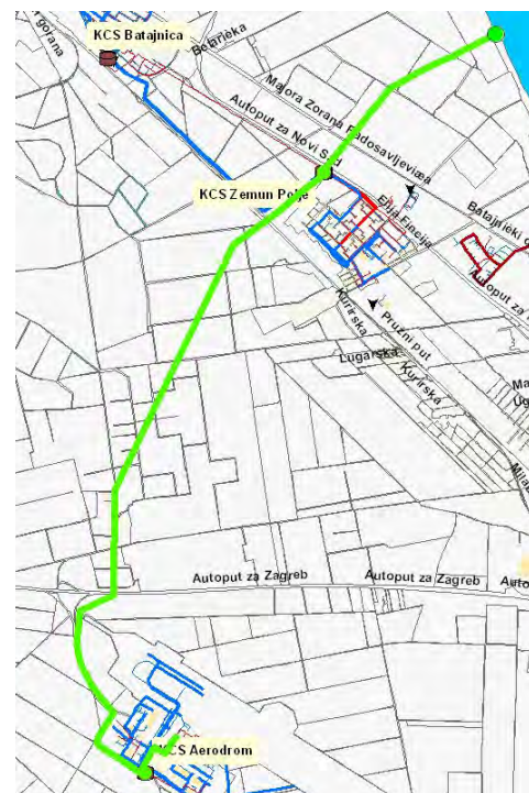
Slika 2. Situacija kolektora i potisnih vodova na pravcu KCS „Aerodrom“ – KCS „Zemun polje 2“ – izliv u reku Dunav
