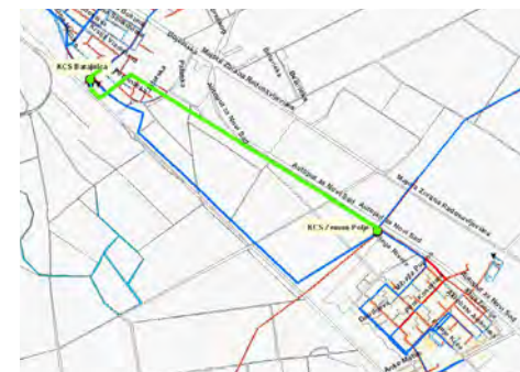
Slika 3. Situacija kolektora i potisnih vodova na pravcu KCS „Batajnica“ – KCS „Zemun polje 2“
